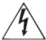
Dieses Symbol verweist auf das Vorhandensein einer nicht isolierten und gefährlichen Spannung im Inneren des Gehäuses und auf eine Gefährdung durch Stromschlag.
